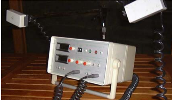
Le Medisend Super II. Appareil de thérapie à basses et hautes fréquences avec 2 inducteurs magnétiques capables de délivrer simultanément deux signaux. L'amplitude et la fréquence peuvent être modulées et le parcours de toutes les fréquences peut être appliqué.
