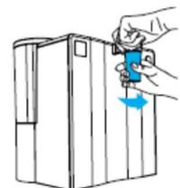
**Für die monatliche Entfernung des Sterilfilters vor der Entkalkung und Desinfektion gehen Sie wie folgt vor:**
